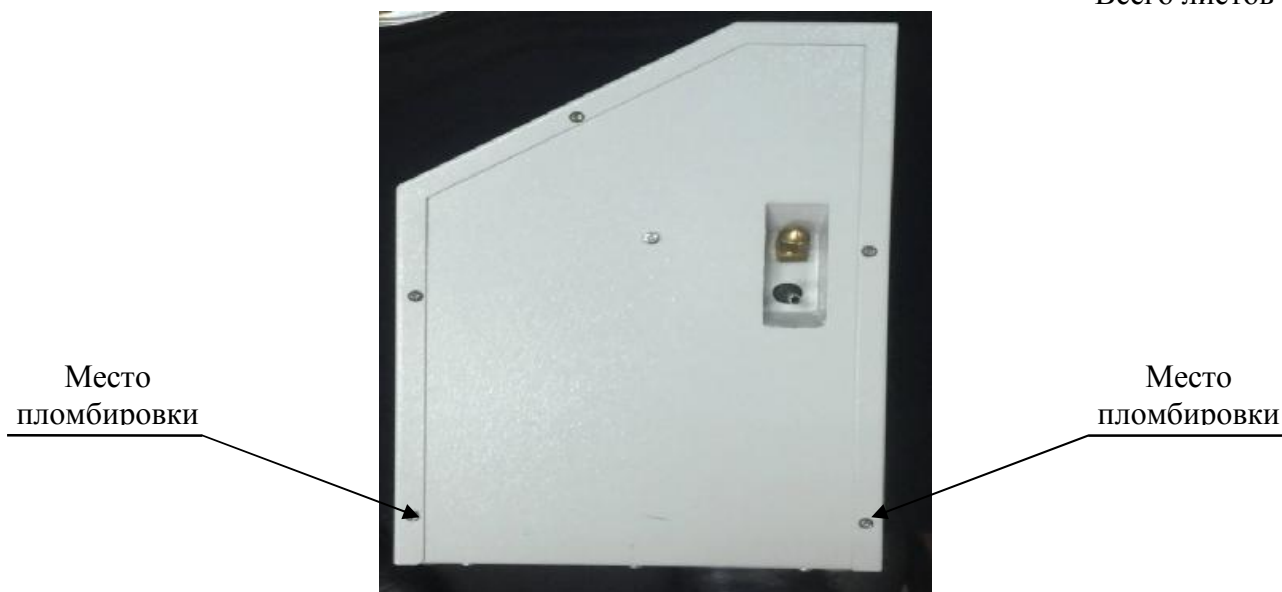
Рисунок 2 – Схема пломбировки от несанкционированного доступа (вид спектрометра - сбоку)
